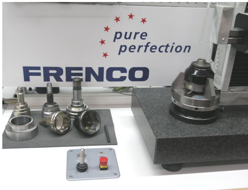
Bild 8: URM mit Planverzahnung (noch nicht funktionsfähig)
